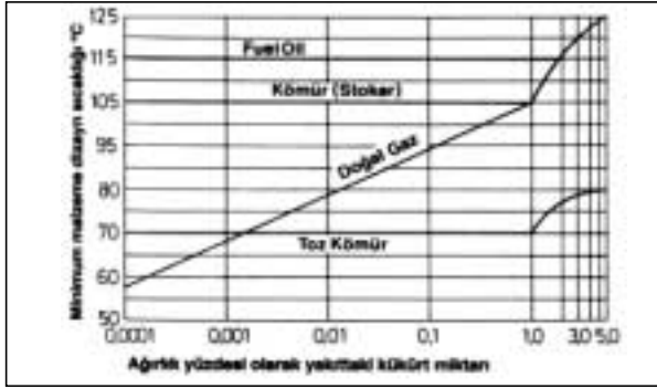
Şekil 10.4 / KÜKÜRT İÇERİĞİNE KARŞILIK MİNİMUM MALZEME SICAKLIĞI
